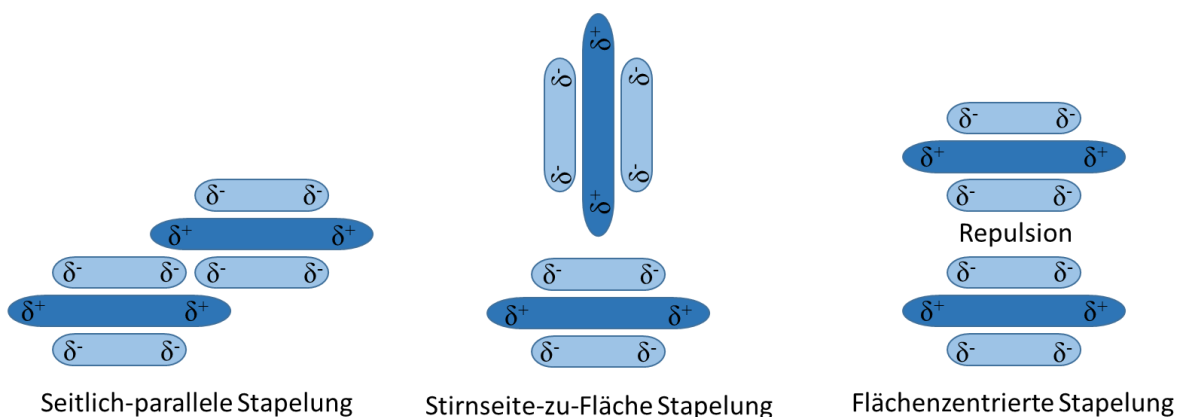
Abbildung 6: Anordnungsmöglichkeiten von Benzol-Molekülen in Anlehnung an [92]
