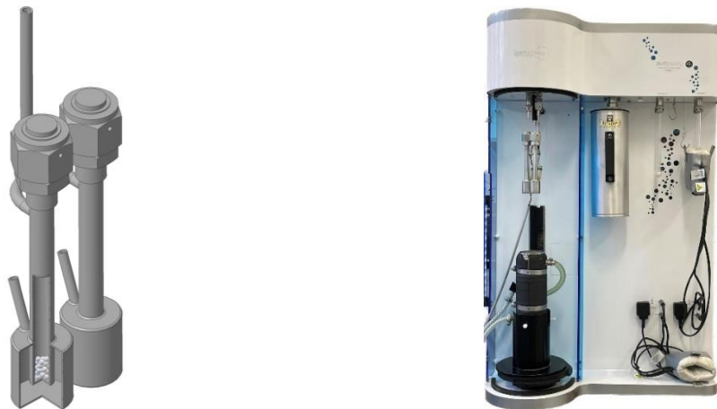
Abbildung 31: Schematisches Sensorgaskalorimeter nach Bläker et al. [118] (links) und Kopplung mit dem autosorb iQ3 (rechts)
