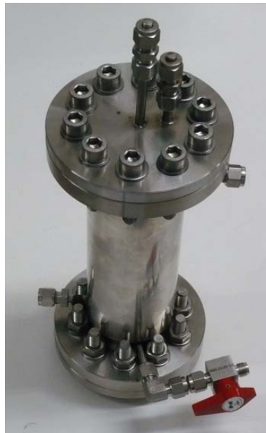
Abbildung 4.4: 2. Prototyp des H_2 -Speichers
