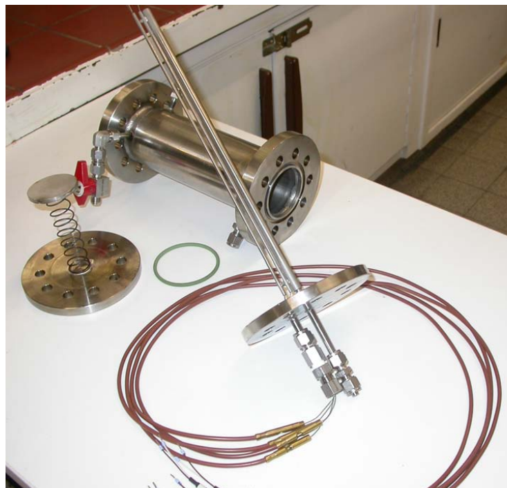
Abbildung A.4: Komponenten der zweiten Speicherversion mit Volumenausgleichsystem
