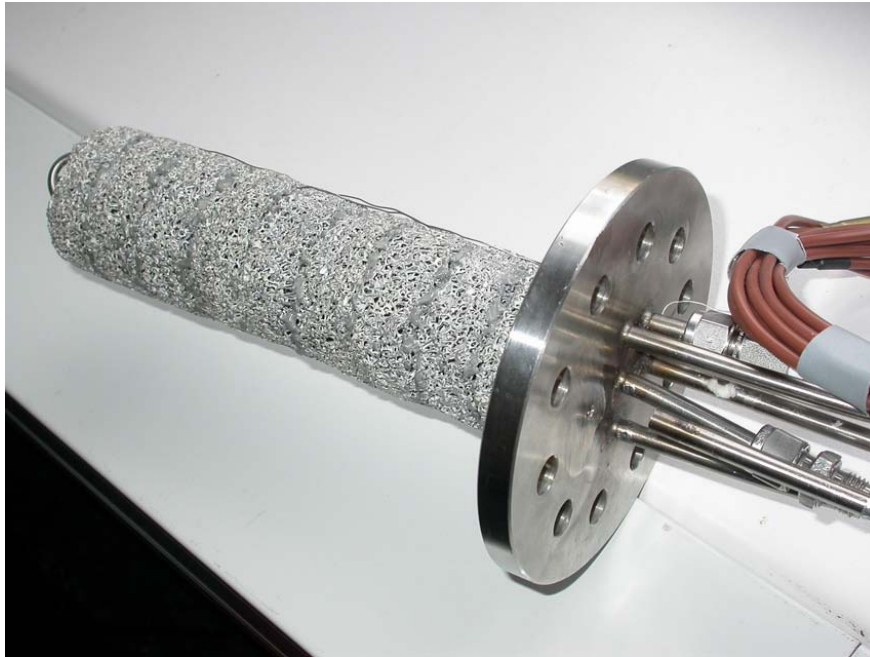
Abbildung 4.7: Al-Schaum-Einsatz als Wärmeübertrager
