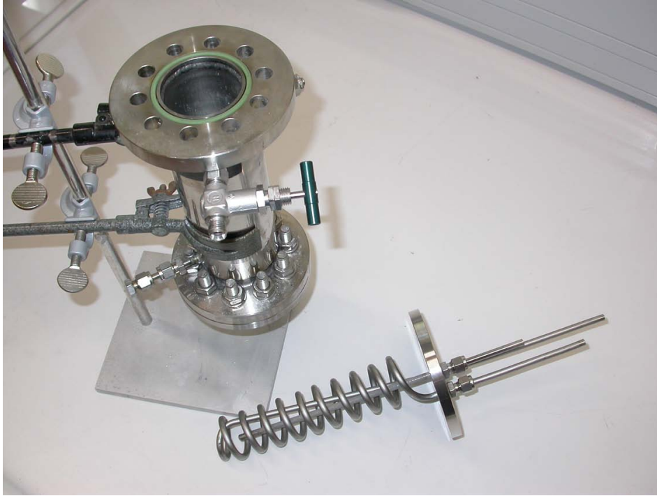
Abbildung 4.5: Prototyp II mit eingesetzter Rohrwendel als Wärmeübertrager
