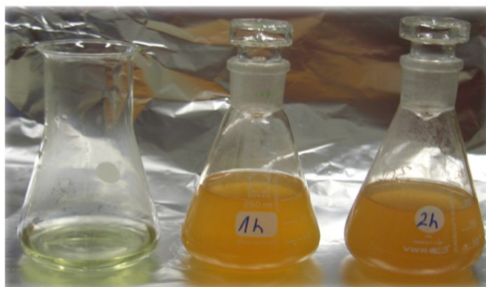
Abbildung 23: 30 M-% MEA-H 2 O-Lösung nach Wärmebehandlung bei 95°C (unbehandelt sowie nach 1 bzw. 2 h)
