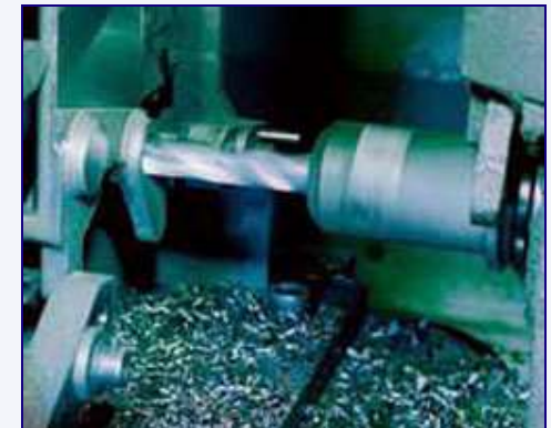
Zerspanprozeß ohne Kühlschmierstoff (Quelle: IWU)
