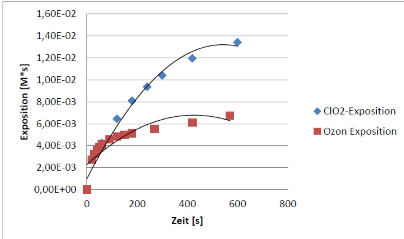
Expositionen der beiden Oxidationsmittel im Abwasser (ClO<sub>2</sub> und O<sub>3</sub>) gegen die Zeit aufgetragen. ClO<sub>2</sub>-Konz.:  $1 \cdot 10^{-4}$  M und O<sub>3</sub>-Konz.:  $2 \cdot 10^{-4}$  M.
