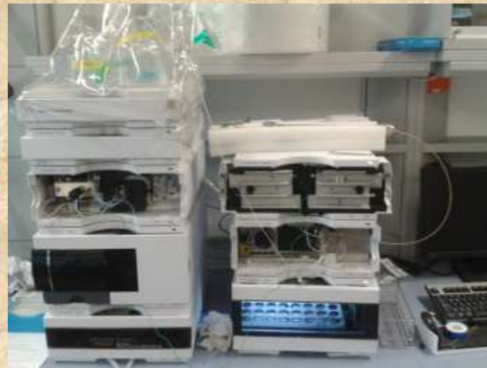
Reinigung von Matrixbestandteilen mit Gelpermeationschromatographie (GPC)
