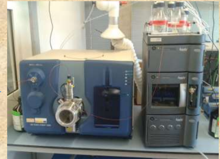
Analyse mit Ultra-Hochleistungsflüssigchromatographie und tandem Massenspektrometrie (UHPLC-MS/MS)
