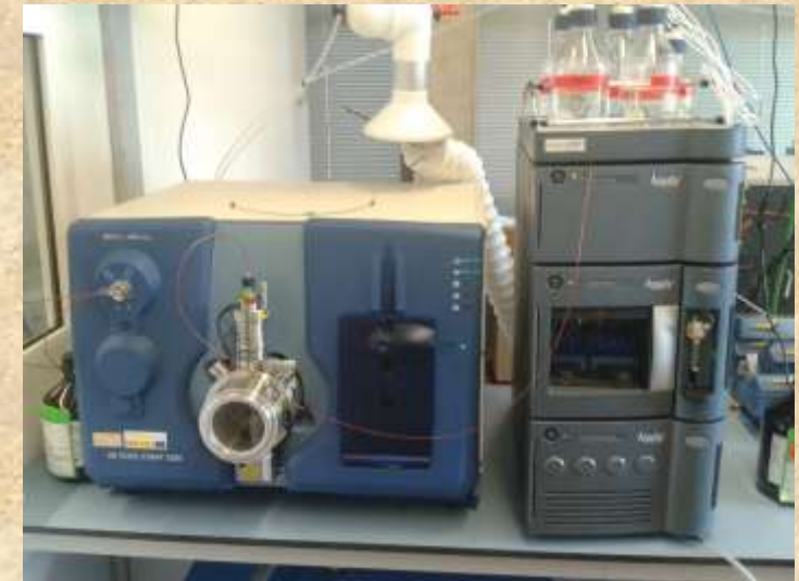
Analyse mit Ultra-Hochleistungsflüssigchromatographie und tandem Massenspektrometrie (UHPLC-MS/MS)
