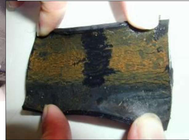
Biofilm on rubber material (Szewzyk, TU Berlin)
