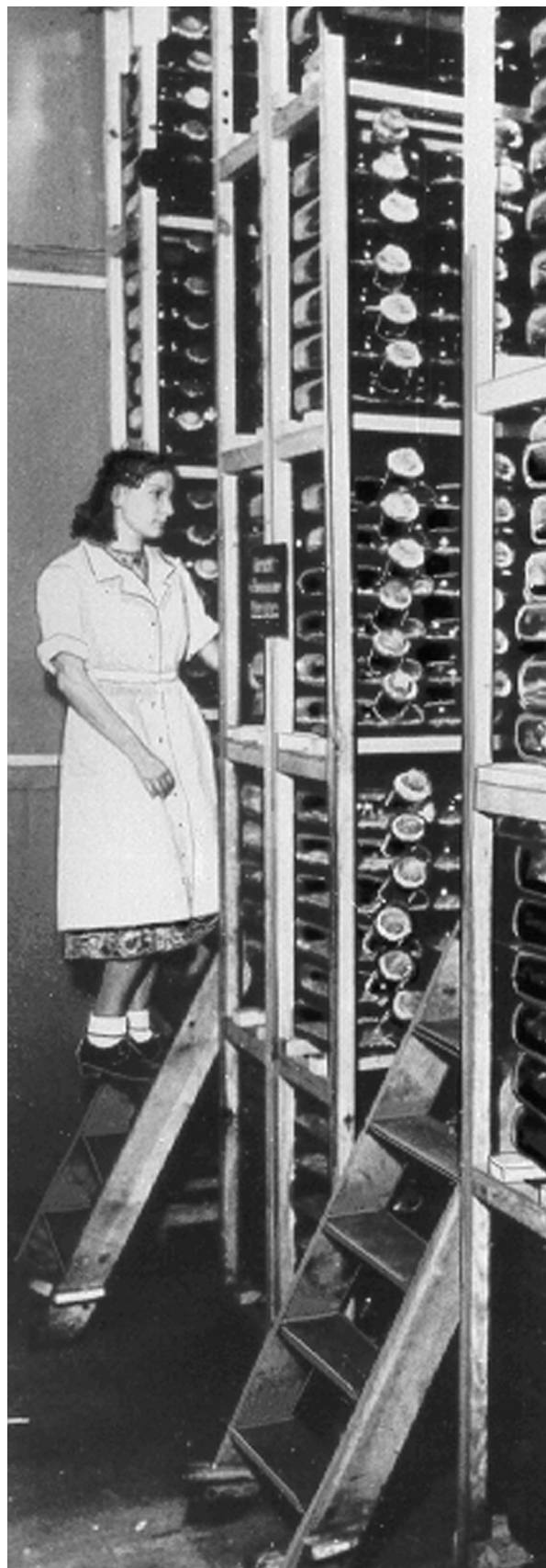
Abb. 7 Produktionsgestell mit Penicillinkolben um 1950, nach [10].
