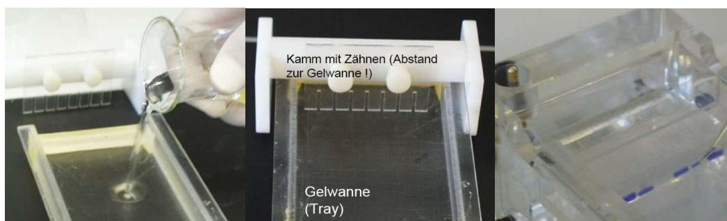
Abbildung 2: Aufbau der Gelkammer, Position des Kammes, Gießen und Beladen des Geles. Ein Kamm wird ca. 1 cm vor dem oberen Ende des Gels platziert (12 Probentaschen).
