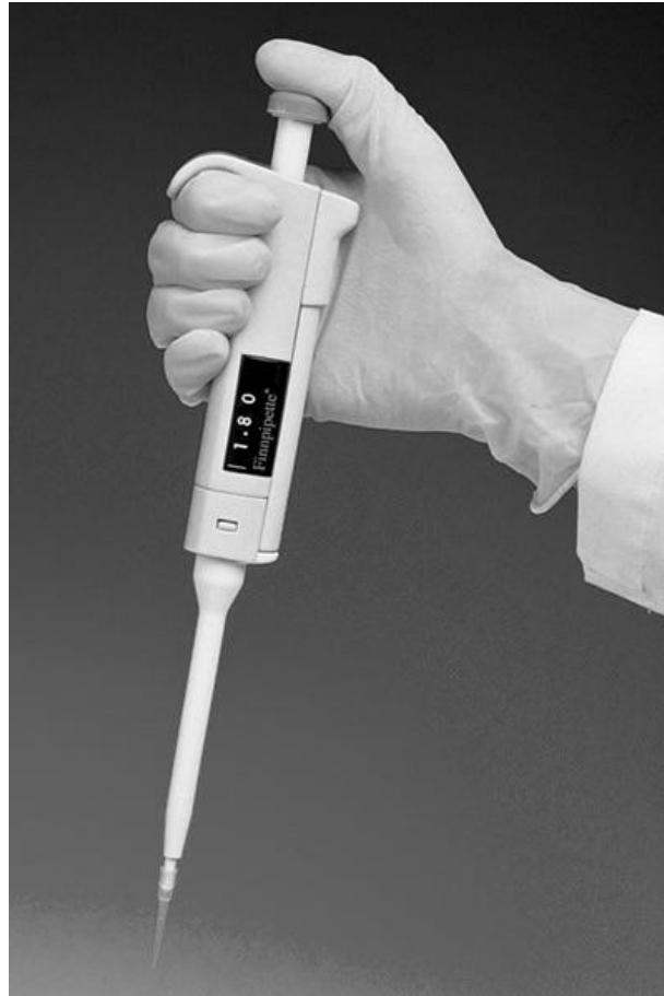
Abb. 1.1. Dieses Bild zeigt die richtige Handhabung einer Kolbenhubpipette. Mit dem Daumen werden der Kolbenhub zum Aufziehen, bzw. Abgeben der Flüssigkeit (hier gezeigt), sowie die Abwurf-taste zum Abwerfen der Einweg-Pipettenspitze bedient.
