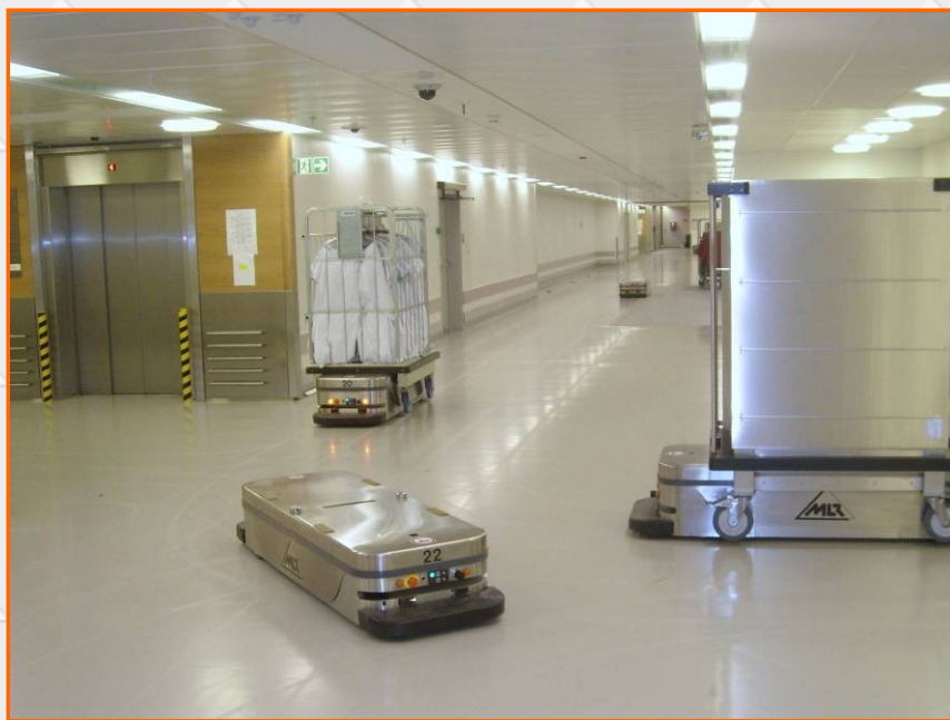
FTS im Klinikum Nye Akershus Universitetssykehus Oslo/Norwegen
