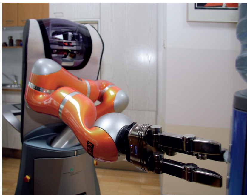
Bild 1 Care-O-bot® 3 greift einen Becher vom Wasser- spender.
