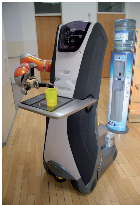
Bild 2 Abstellen des Bechers auf dem Tablett als Basis für die sichere Übergabe an die Bewohner.
