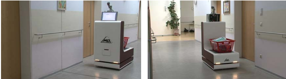
Abb. 7-8: CASERO ® transportiert einen Wäschekorb. © MLR System GmbH, Ludwigsburg
