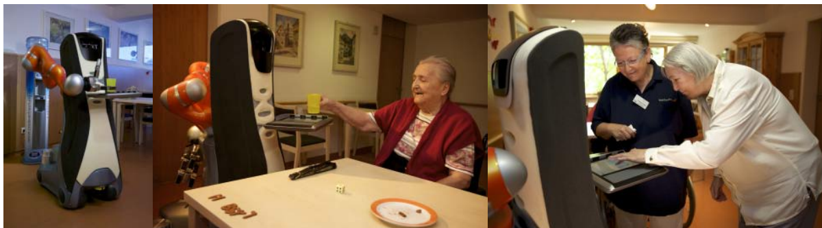
Abbildung 1: Aufgabe des Care-O-bot 3: Zapfen von Getränken am Wasserspender (links), Überreichen des Getränks an eine Bewohnerin (Mitte), Memory spielen am Bildschirm des Care-O-bot (rechts)
