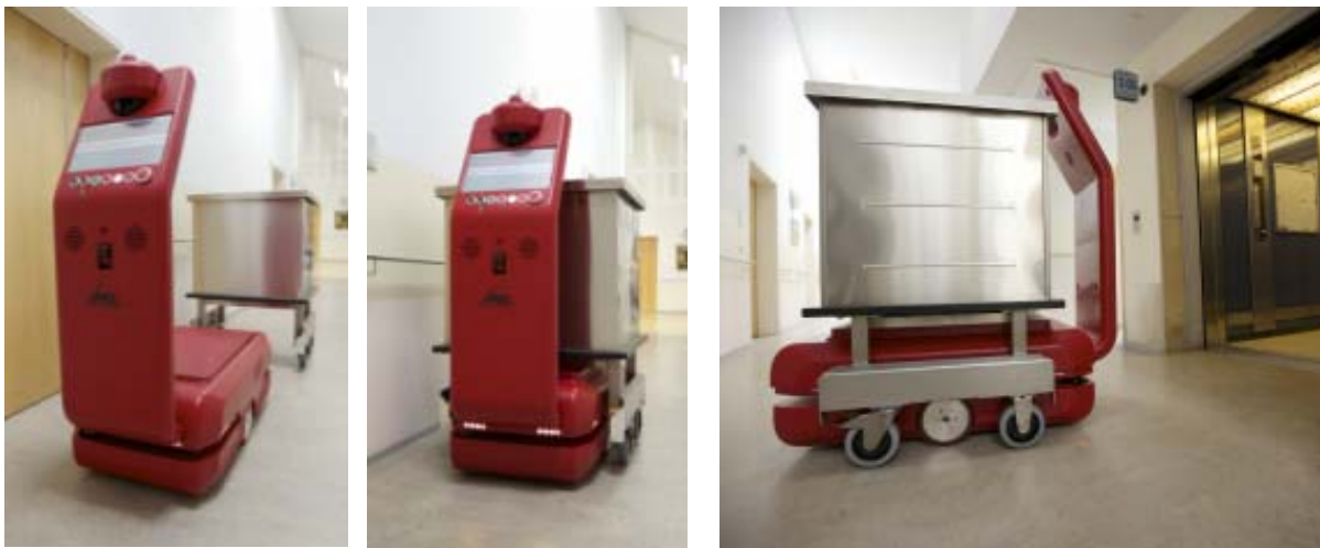
Fig. 10: CASERO im Praxiseinsatz: Aufnahme des Wäschebehälters und Transport in den Keller (Quelle: Fraunhofer IPA)
