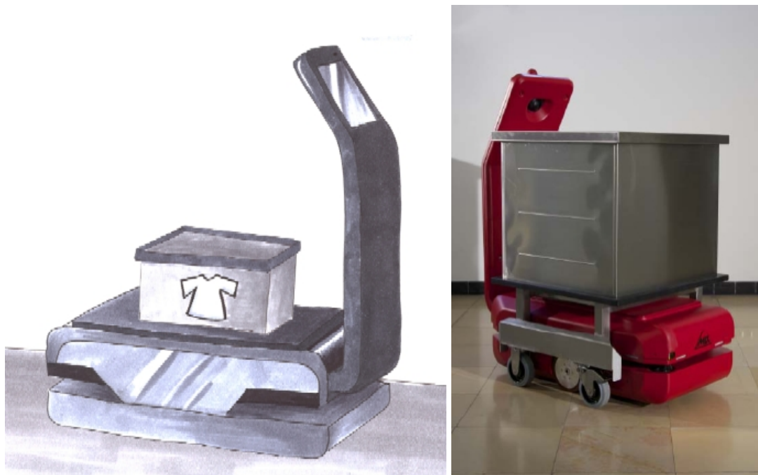
Abb. 7-8: Das Bild links zeigt die für die Szenarienabstimmung verwendete Skizze des Wäschetransportszenarios, rechts der in den Pilotanwendungen zum Einsatz gekommene Container für die Schmutzwäsche. (Quelle: Abb. 7 User Interface Design GmbH, Abb. 8 Fraunhofer IPA)
