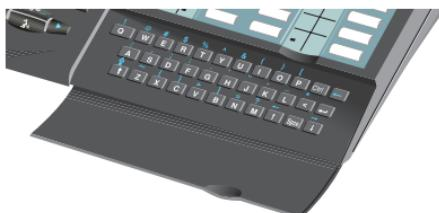
Diese Tastatur dient zur Nachrichtenerstellung, zur Namenwahl und zur Programmierung.
