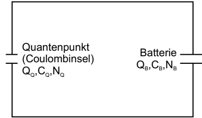
Abbildung 5: Einfaches Ersatzschaltbild zur Coulombblockade
