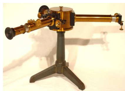
Spektroskop von Heele, Berlin (um 1890). Standardgerät in der Ausführung nach Kirchhoff und Bunsen als „kleiner Spectralapparat zum Gebrauch in Laboratorien“ (1862).
