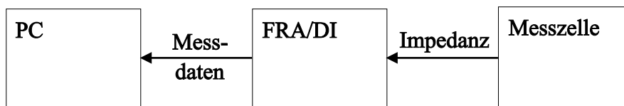
Abbildung 3.14: Blockschaltbild zu den Impedanzmessungen.
