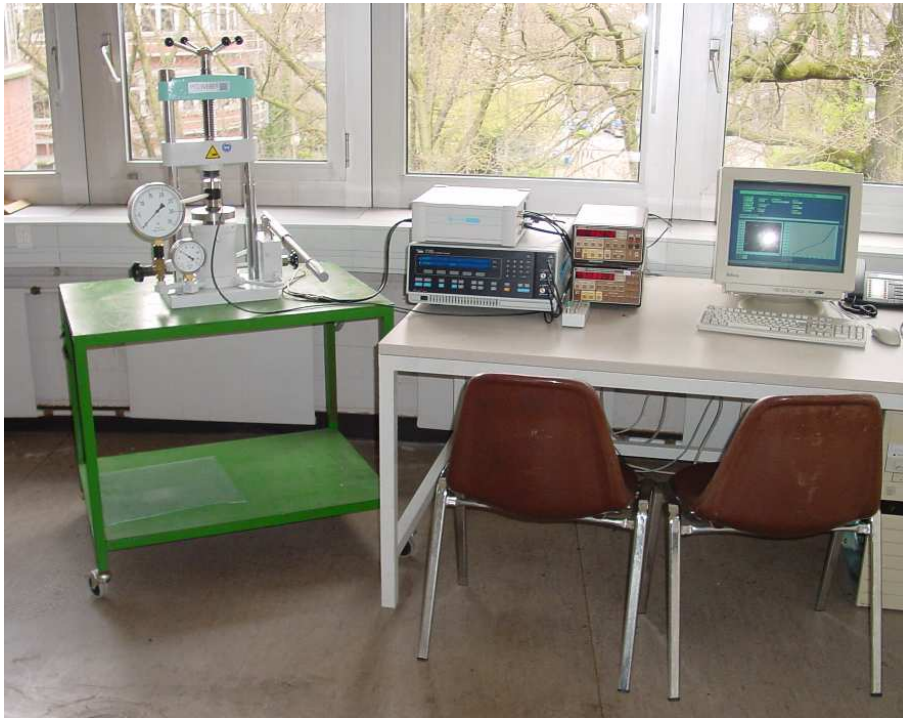
Abbildung 3.9: Experimenteller Aufbau zu den Diodenmessungen.
