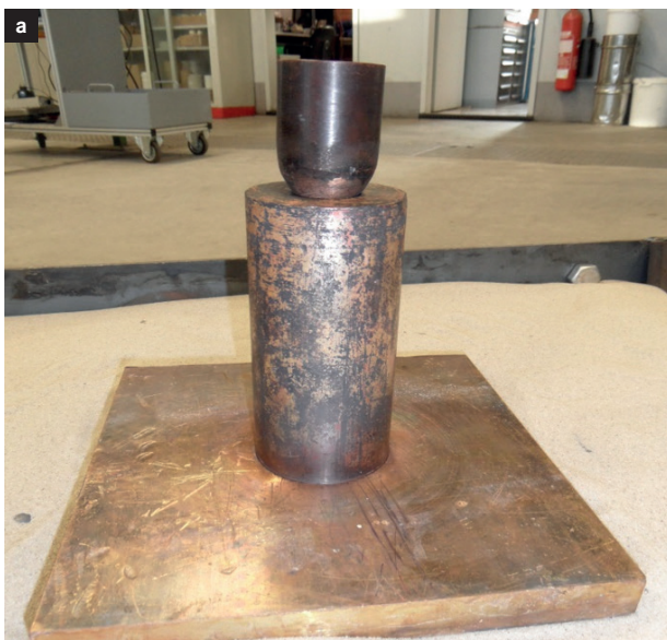
Bild 2: Zylindrische Form aus Kupfer (a), die vor Versuchsbeginn auf einer Kupferplatte (b) positioniert wird, in der sich eine Vertiefung für das Magnesium befindet. Der in Bild a) dargestellte Stempel wird nach dem Einfüllen der Schmelze auf die Schmelzoberfläche gesetzt.
