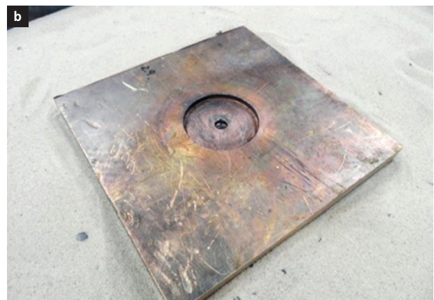
Bild 2: Zylindrische Form aus Kupfer (a), die vor Versuchsbeginn auf einer Kupferplatte (b) positioniert wird, in der sich eine Vertiefung für das Magnesium befindet. Der in Bild a) dargestellte Stempel wird nach dem Einfüllen der Schmelze auf die Schmelzoberfläche gesetzt.
