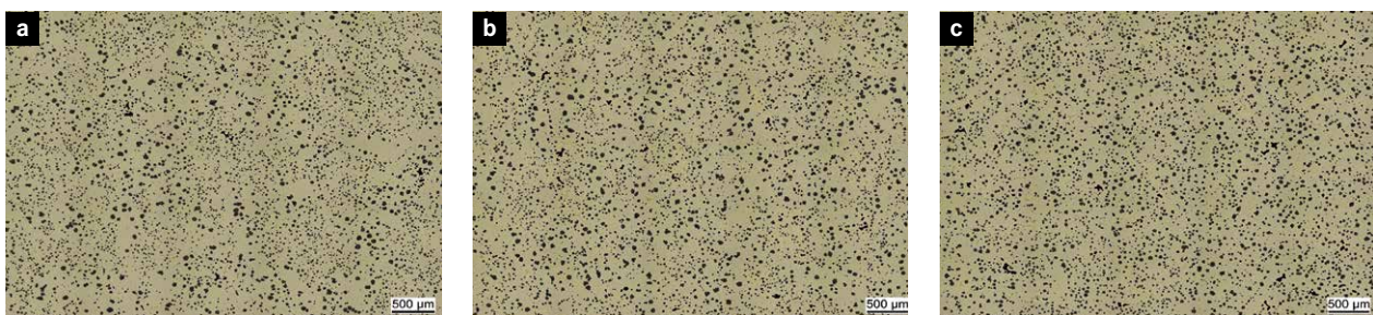
Bild 4: Gefüge eines GJS-Kreislaufmaterials nach dem Glühen bei 1100 °C nach einer Haltezeit von a) 5 min, b) 10 min, c) 15 min.
