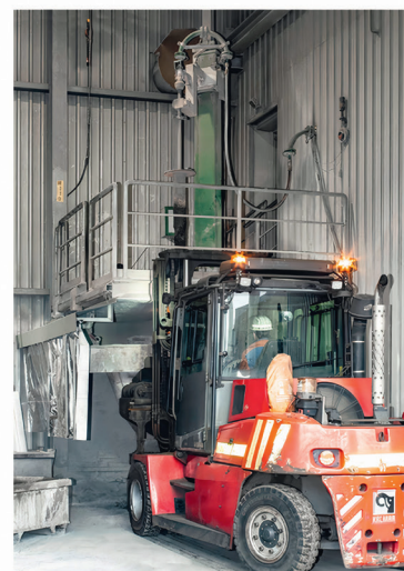
Bild 3: Automatisierte Einblasanlage zur kalkbasierten Entschwefelung, a) Anlagenlayout, b) Einblasvorrichtung, c) Einblasanlage [24]
