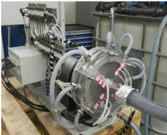
*Prüfstand kleine Radseitenräume*
