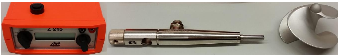
Abbildung 6 OTT Zählgerät Z215 (links) und OTT Kleinflügel C2 + Schaufel (rechts)
