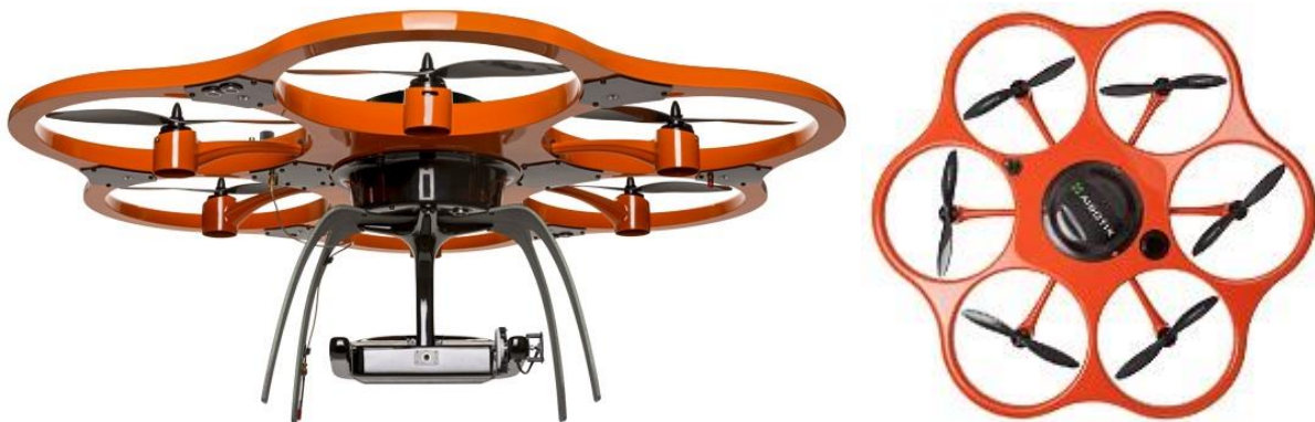
Abbildung 9 Aibotix 6 V2 Froschperspektive (links) und Draufsicht (rechts) (Homepage Aibotix GmbH)
