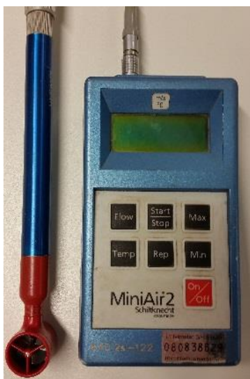
Abbildung 5 Schildknecht MiniAir2 Messflügel mit Auswerteeinheit
