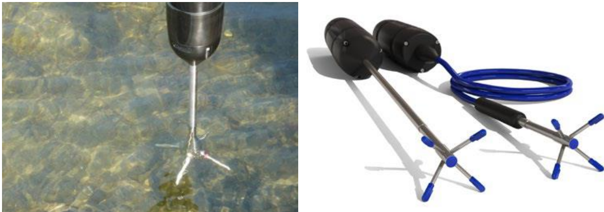
Abbildung 4 Vectrino Feldsonde im Einsatz (links) und Laborsonde (rechts) (Prospekte Vectrino Feld- bzw. Laborsonde)
