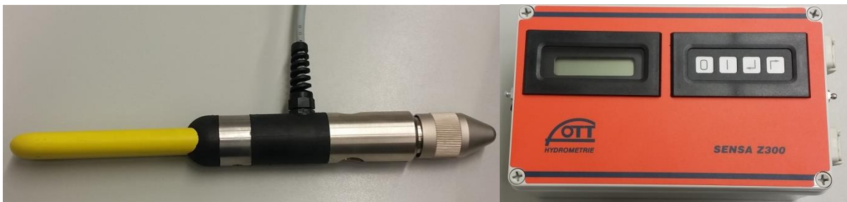
Abbildung 7 OTT Nautilus C2000 (rechts) und OTT Sensa Z300 (links)
