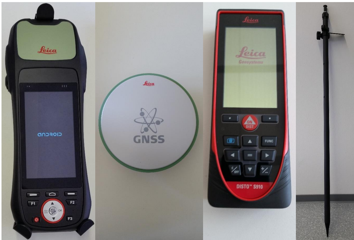
Abbildung 8 Leica Zeno20 (links), externe Antenne (Mitte links) und Leica Disto S910 (Mitte rechts), Mess- und Montagestab für die externe Antenne (rechts)
