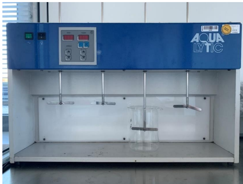
Abbildung 3.1.1-1: Für Adsorptions- und Fällungsversuche verwendetes Reihenrührwerk der Fa. Aqualytik
