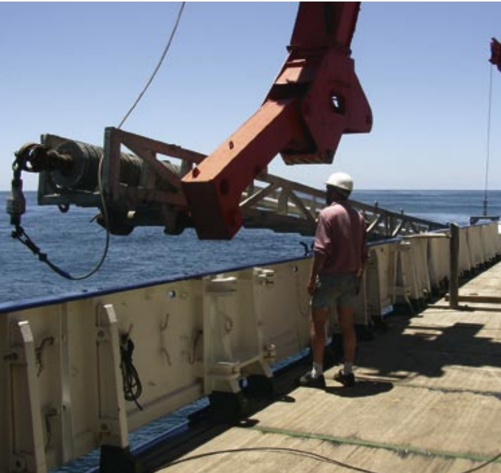
An Bord des Forschungsschiffes „Meteor“: Mit einem „Schwerelot“ werden Sedimentkerne aus dem Meeresboden gewonnen.
