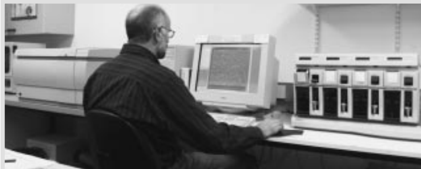
(3) Anlage zur Messung von Genaktivitäten über Biochips. Im Laserscanner (links) werden die Biochips ausgewertet, in der Waschstation (rechts) können bis zu vier Chips parallel mit Wasch- und Färbelösungen beschickt werden. In der Mitte ein leistungsfähiger PC für die Steuerung der Anlage und die Datenauswertung.
