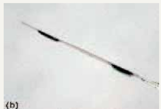
Abbildung 9: a) Aufsicht und b) Seitenansicht eines IR-Implantats mit GaAs-Photoempfängern und Silikonkapselung, Länge 6,5 mm, Breite 2 mm, max. Gesamtdicke 120 µm.
